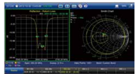
듀얼 모드 디스플레이(VSWR/DTF의 동시 측정, 독립적으로 테스트 할 수 있어 측정 시간을 단축)
