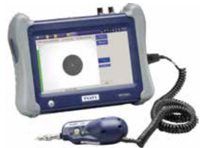
Fiber Scope(P5000i) 장착
